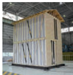
実大2階建住宅の振動台実験
