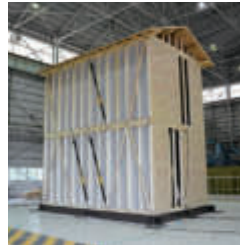
実大2階建住宅の振動台実験
