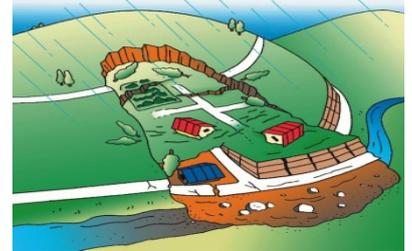
斜面の一部あるいは全部が地下水の影響と重力によってゆっくりと斜面下方に移動する現象です。
