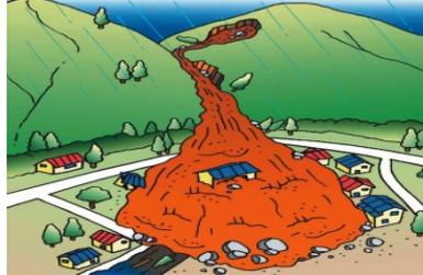
山腹・谷底にある土砂が長雨や集中豪雨などによって一気に下流へと押し流される現象です。
