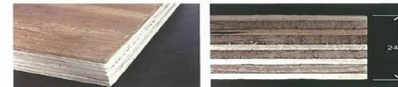
床に使用する構造用合板は厚さ24mm。当社では屋根を形成するパネルに使用される構造用合板が厳しい検査をクリアした強度を誇る高品質なものを採用しています。24mm厚の構造用合板は剛性構造を実現し、地震による床から壁へ伝わるダメージを抑制します。
