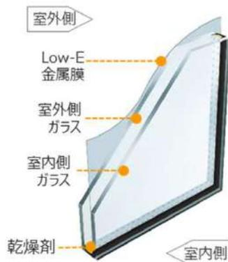
ガラスをLow-E金属膜でコーティングすることによって、ガラスの断熱性能を高めた複層ガラスです。
