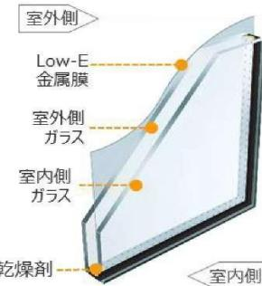
ガラスをLow-E金属膜でコーティングすることによって、ガラスの断熱性能を高めた複層ガラスです。
