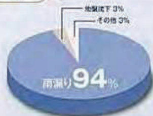
瑕疵事故内容の割合 ①2009年10月以降 専用付保物件44万件的検査自宅に対して 当社調べ
