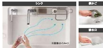
シンクの底に3°の傾斜を設けることで、すべり台をすべるように排水口へと水やごみが流れます。さらに排水口と網かこの形状にも傾斜を持たせ、3つのすべり台の合わせ技でシンク内のきれいを保ちます。
