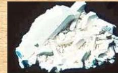
ホウ素は薬剤などの有機物ではないので、経年による揮発・滅失はありません。そのため、一度施工すればそのホウ酸が存在し続ける限り、効果が持続します。日本での木材保存剤は一般的には農薬の合成殺虫剤です。その農薬成分は、わずかながら蒸散しつづけ、健康を害す恐れがあります。また、3～5年で蒸散しつくして無処理状態になるので、そのたびに再処理費用が発生します。
