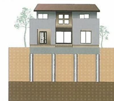
基礎部分に沿って筒状に掘削した穴にセメント系固化材溶液を流入し、柱状の支持体をつくります。
