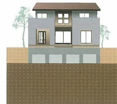
地盤を格子状に掘削し、固化剤を混合した改良土で格子状の支持体をつくります。
