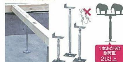
当社では優れた耐久性と強度を誇る鋼製束を厳選して採用。基礎のベース部分と大引きの固定を確実なものにします。この鋼製束には防錆加工が施されているため、シロアリや腐朽菌に侵されにくい仕様となっています。
