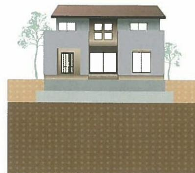
軟弱な地盤の土にセメント系固化材を混ぜて地盤を強化します。
