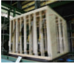
48回加振した実大住宅の振動台実験
