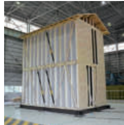
実大2階建住宅の振動台実験
