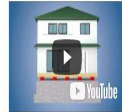
基礎から土台への揺れの伝わりが小さくなり、新耐震基準を超える大型地震による倒壊を防ぎます。
