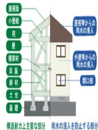
構造耐力上主要な部分 雨水の浸入を防止する部分
