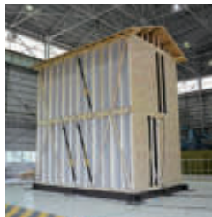
実大2階建住宅の振動台実験
