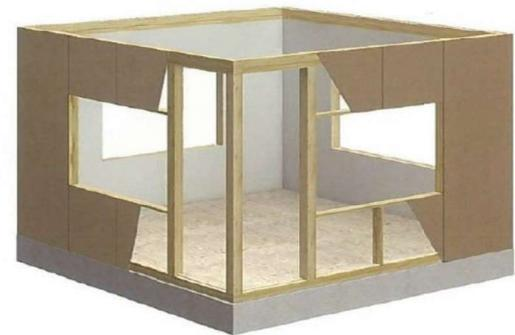
ベタ基礎とは、建物の底部のコンクリートが隙間なく連続し、基礎の底部が一枚の板状になっている基礎のことです。地盤に施工された鉄筋コンクリート面全体で建物を支える構造になっているため、地震や台風などの衝撃を効果的に地盤へ逃がす事が可能です。地面をコンクリートで覆うので地面から上がってくる湿気を防ぎ、シロアリの侵入も防ぎます。
