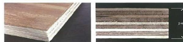
床に使用する構造用合板は厚さ24mm、引剥では層間を形成するパネルに使用される構造用合板は厳しい検査をクリアした強度を誇る高品質なものを採用しています。24mm厚の構造用合板は剛性構造を実現し、地震による床から壁へ伝わるダメージを抑制します。
