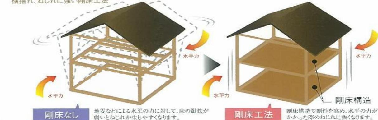
剛床工法の仕組み
