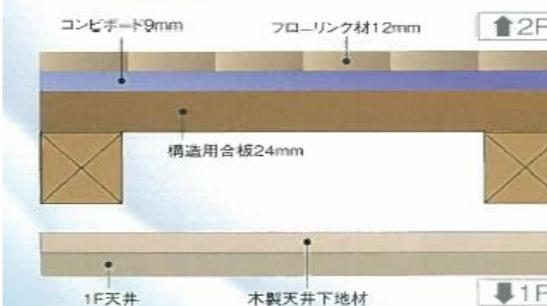
1階と2階の床には剛床工法を採用しました。梁に24mm厚の構造用合板を直接留め、柱・梁と床面を一体化。地震の際の横揺れに効果を発揮し、一般的な板太工法に比べて横からの力に対する強度が約2倍になりました。
