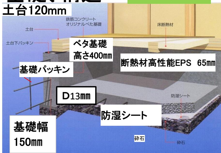
ベタ基礎とは、建物の底部のコンクリートが隙間なく連続し、基礎の底部が一枚の板状になっている基礎のことです。地盤に施工された鉄筋コンクリート面全体で建物を支える構造になっているため、地震や台風などの衝撃を効果的に地盤へ逃がす事ができます。地面をコンクリートで覆うので地面から上がってくる湿気を防ぎ、シロアリの侵入も防ぎます。
