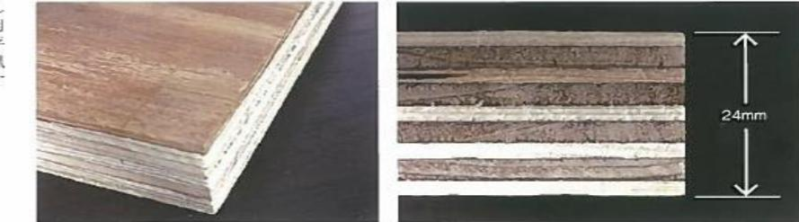
床に使用する構造用合板は厚さ24mm。当社では屋根を形成するパネルに使用される構造用合板とともに、厳しい検査をクリアした強度を誇る高品質なものを採用しています。24mm厚の構造用合板は剛性の高い床構造を実現し、地震による床から壁へ伝わるダメージを抑制します。
