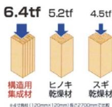
梁・桁材の長期許容曲げ耐力比較
