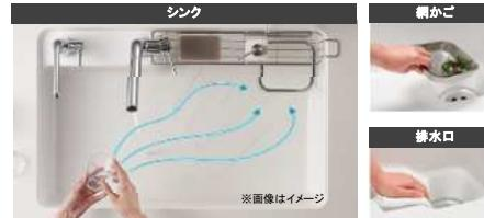
シンクの底に3°の傾斜を設けることで、すべり台をすべるよう排水口へと水やごみが流れます。さらに排水口と網かごの形状にも傾斜を持たせ、3つのすべり台の合わせ技でシンク内のきれいを保ちます。
