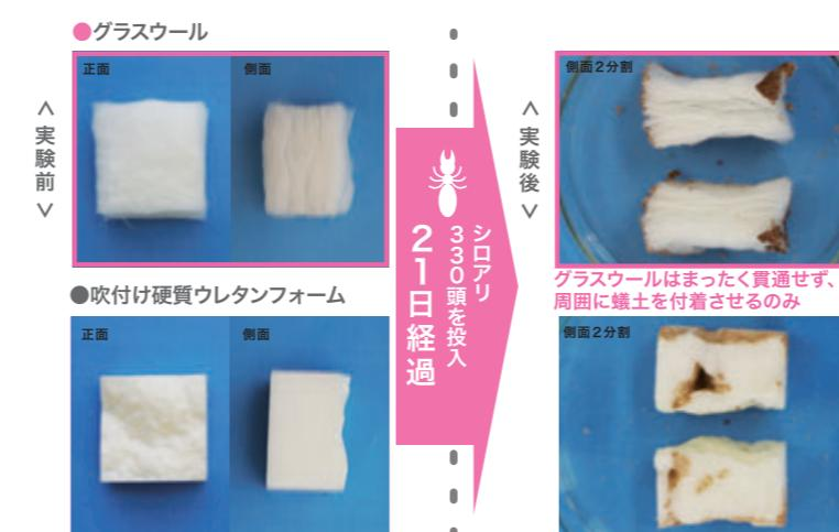
飼育容器の硬質石膏の上に厚さ約1mmのプラスチック製の網を置き、その上に餌用すぎ材を置き、さらにその上に試験断熱材をびつたり重なるように置いた。イエシロアリの職蟻300頭、兵蟻30頭を投入。28±2°Cの暗所に21日間所静置し食害調査終了後、試験体を飼育容器から取り出し、試験体の食害程度を記録。
